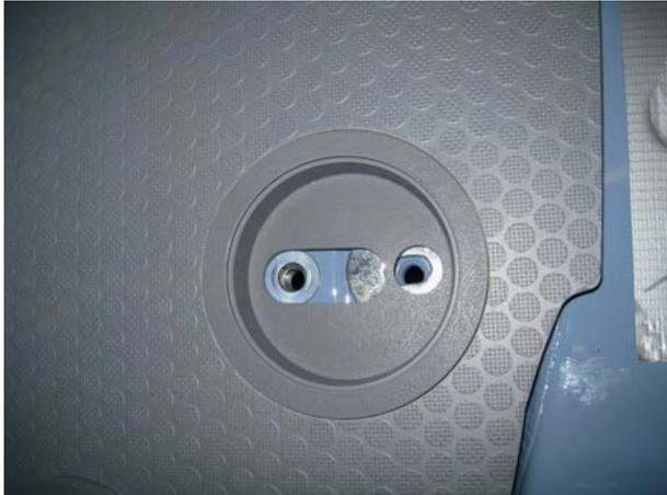
Bohrung mit Stufenbohrer setzen; Ungleichheit mit Karosseriescheibe ausgleichen (nicht im Lieferumfang)
